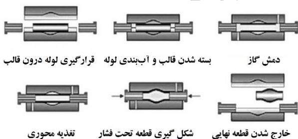
شکل (۱): فرآیند هیدروفورمینگ لوله [۱۸].
