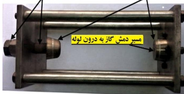
شکل (۴): مجموعه آببندی لوله.
