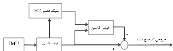
شکل (۵): تصحیح سامانه ناوبری اینرسی در زمان قطع سیگنال GPS با استفاده از شبکه عصبی و فیلتر کالمن.
