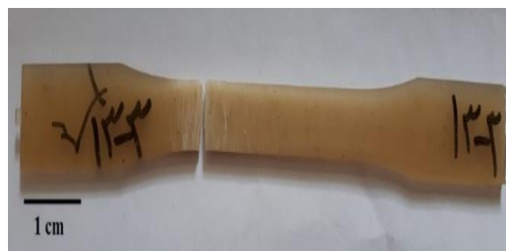
شکل (۲): نمونه گسیخته شده بعد از آزمون کشش.
