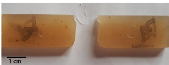
شکل (۳): نمونه شکسته شده بعد از آزمون ضربه.
