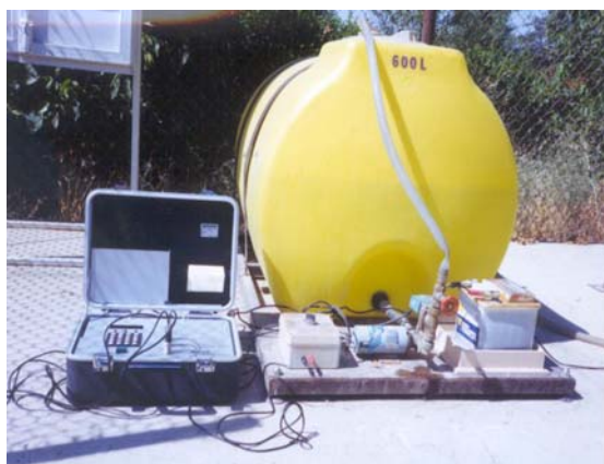
عکس شماره ۱- دستگاه شبیه سازی باران مؤسسه تحقیقات جنگلها و مراتع به انضمام مخزن آب و دستگاه کنترل مرکزی
