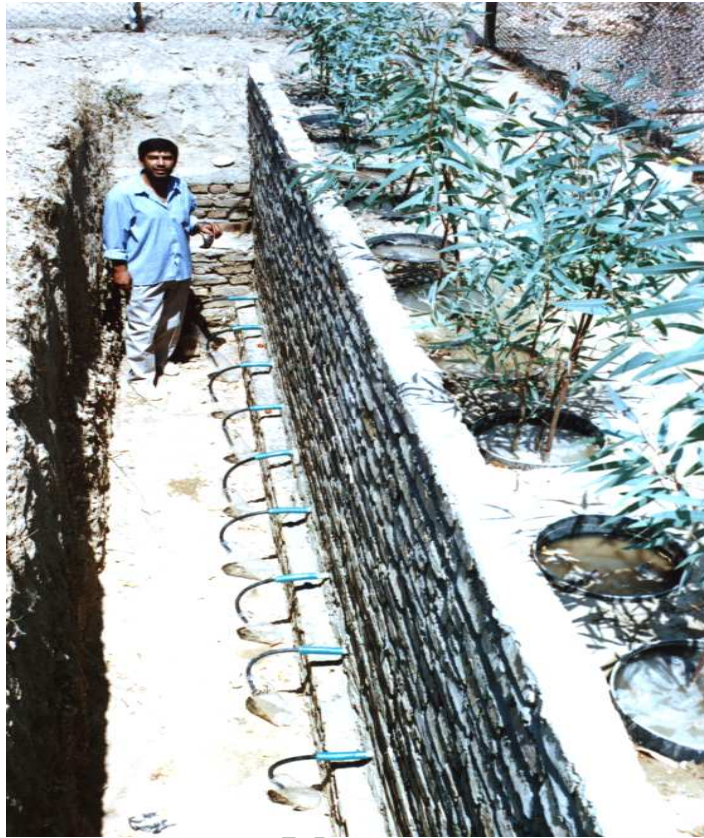
شکل ۲- آزمایش آبشویی در شرایط مزرعه. (لوله های تیمار (نهال+خاک) و شاهد (خاک) به طور یک در میان قرار گرفته و زه آب خروجی هر لوله به طور مجزا جمع آوری شد).
