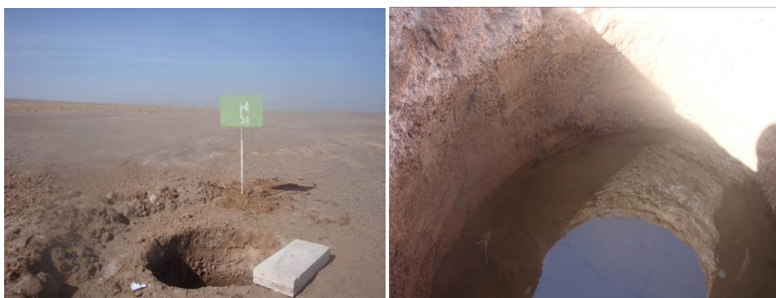
شکل ۳- تصویری از چاهک ۲ و سطح آب داخل آن
