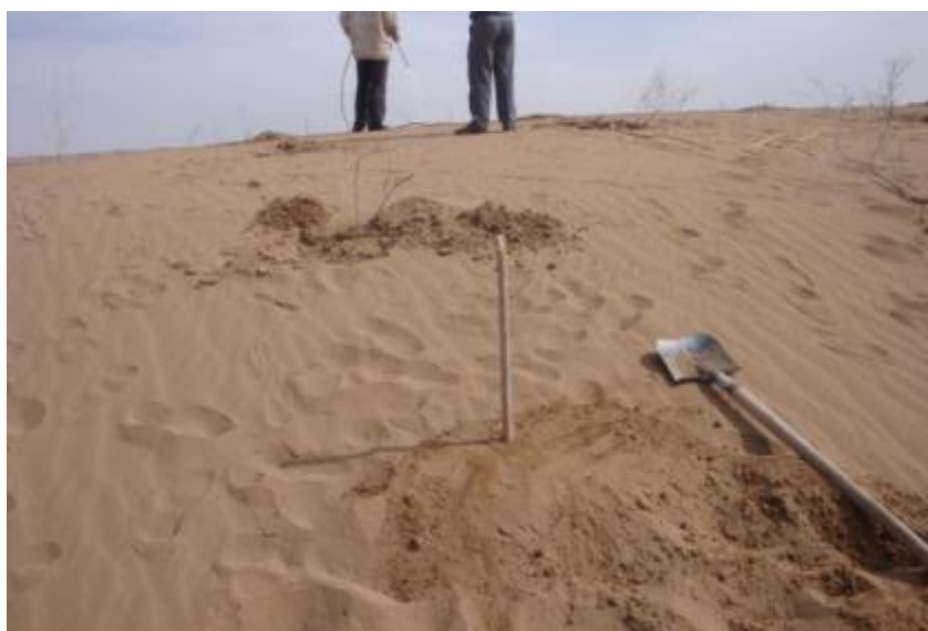
شکل ۴- تعبیه شاخص برای اندازه‌گیری جابجایی ماسه
