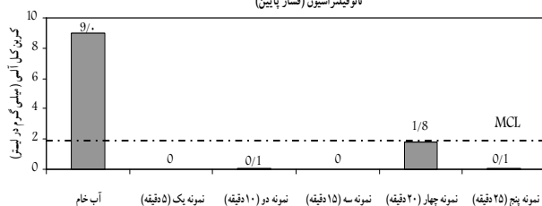
شکل ۲- فرایند نانوفیلتراسیون در فشار عملیاتی ۴ بار برای حذف کربن کل آلی آب خام
