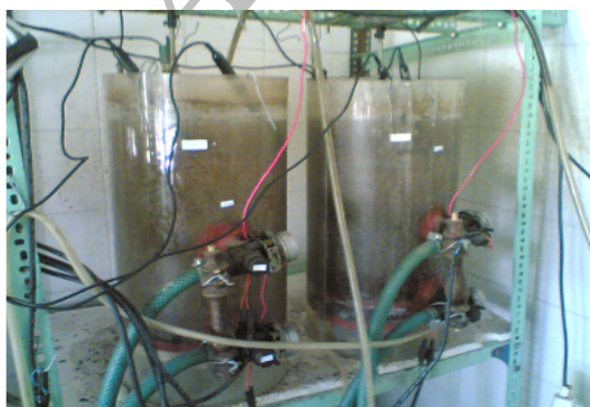
شکل ۱- نمای کلی پایلوت راکتورهای ناپیوسته متوالی
