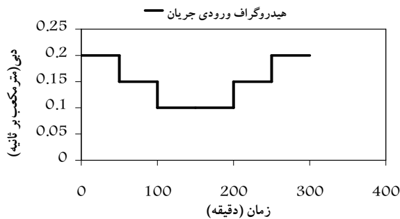
شکل ۲- هیدروگراف ورودی جریان به کانال آزمایشگاهی
