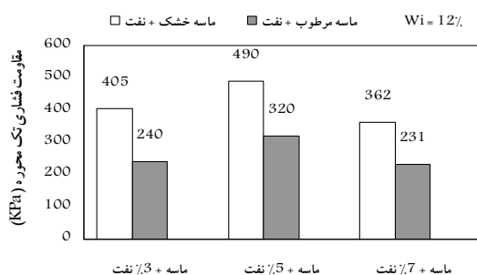
شکل ۵- تأثیر رطوبت اولیه ماسه‌ها (نمونه B) بر روی مقاومت فشاری نمونه‌های اصلاح شده
