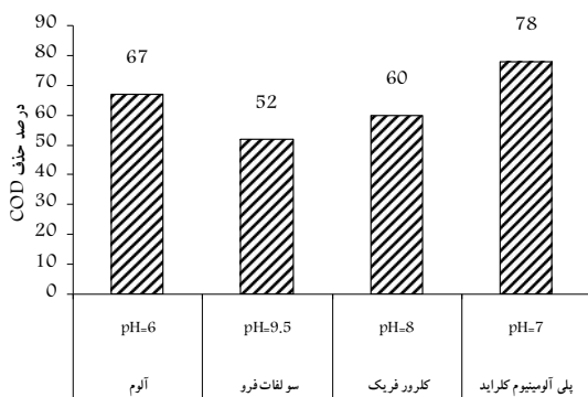
شکل ۲- راندمان حذف COD در بهینه pH مربوط به هر یک از منعقد کننده‌ها (مقدار منعقد کننده برابر ۵۰ میلی‌گرم در لیتر و غلظت آنتی بیوتیک برابر ۲۰۰ میلی‌گرم در لیتر، زمان برابر ۶۰ دقیقه)
