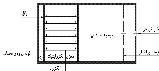
شکل ۱- پلان راکتور الکتروکواگولاسیون
