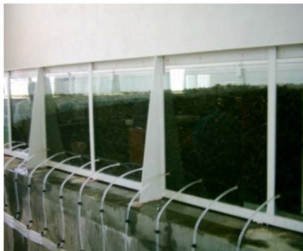
شکل ۵- نمایشی از فلوم و پیزومترها در حین آزمایش
