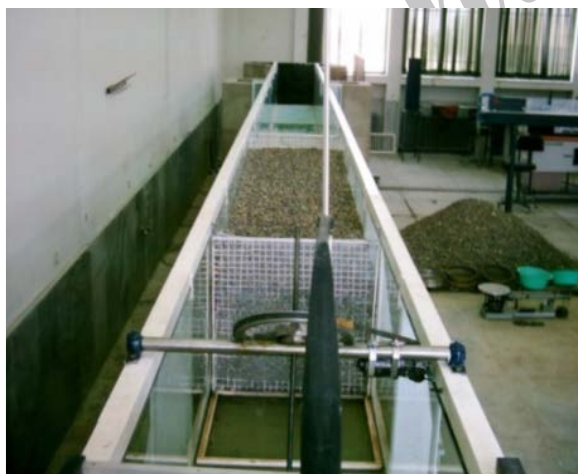
شکل ۴- نمایشی از فلوم در هنگام پرکردن محیط متخلخل نگاه به سمت بالادست
