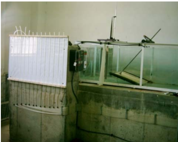
شکل ۲- نمایشی از جزئیات انتهایی فلوم مورد استفاده
