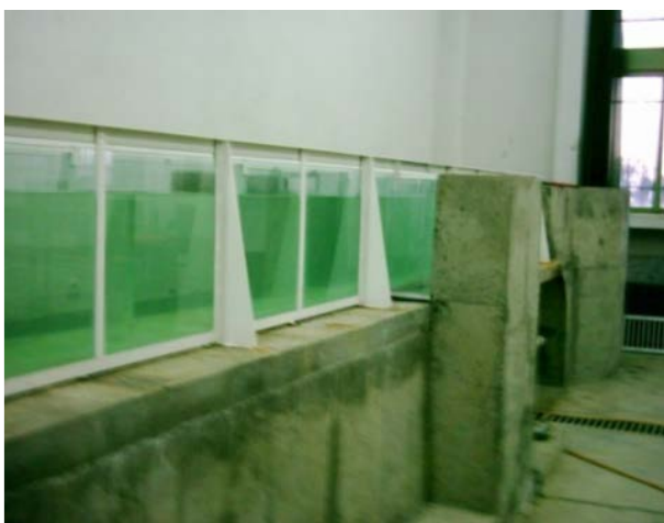
شکل ۳- نمایشی از فلوم و سرریزهای جانبی آن، نگاه به سمت راست
