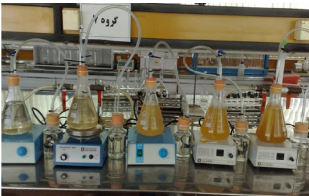
شکل ۱- نمایی از راکتورهای بی‌هوازی استفاده شده در این پژوهش
