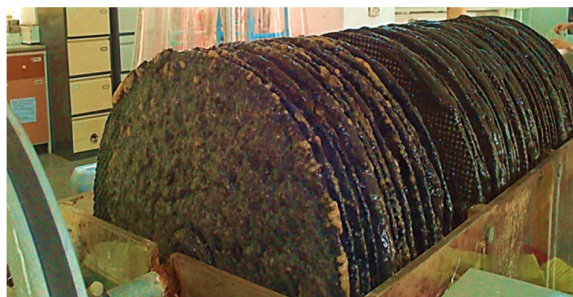
Fig. 2. The formation of attached biofilm (on discs) at the end of discontinuous operation cycle of the reactor شکل ۲- تشکیل بیوفیلم چسبیده بر روی دیسک‌ها در انتهای دوره کارکرد ناپیوسته راکتور
