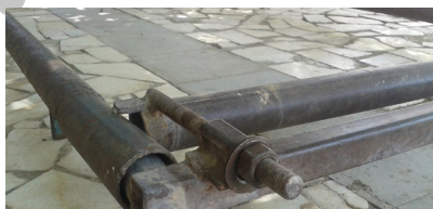
تصویر ۱. دار گلیم‌بافی افقی از جنس آهن. پیچ تعبیه‌شده روی دار برای تنظیم چله‌ها کاربرد دارد و در دو طرف سردار تعبیه شده است. (تصویر از روستای دارستان در ۲۵ کیلومتری جنوب شهرستان سیرجان. منبع: نگارنده)
