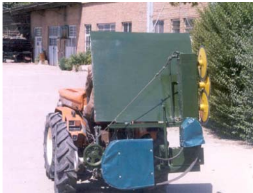
الف- ماشین در حال قرارگیری در وضعیت تردد جاده‌ای ب- ماشین پس از قرارگیری در وضعیت تردد جاده‌ای شکل ۱۱- آماده کردن ماشین برای وضعیت تردد جاده‌ای
