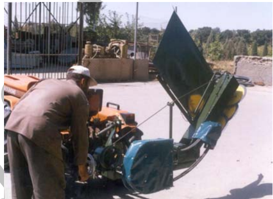
الف- ماشین در حال قرارگیری در وضعیت تردد جاده‌ای ب- ماشین پس از قرارگیری در وضعیت تردد جاده‌ای شکل ۱۱- آماده کردن ماشین برای وضعیت تردد جاده‌ای
