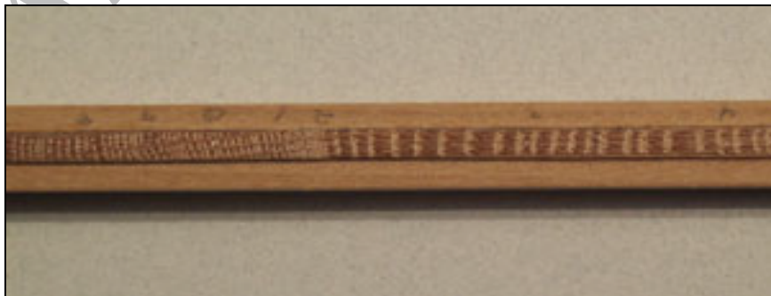
شکل ۲- نمونه آماده شده که برای نگهداری و محافظت بر روی ناودان چوبی سوار شده است.
