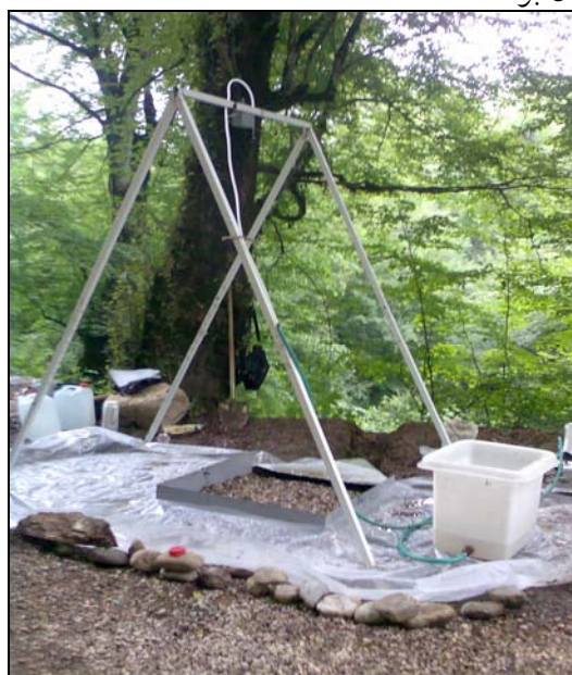
شکل ۱- استقرار باران‌ساز در سطح جاده به منظور جمع‌آوری مقدار رواناب و رسوب
