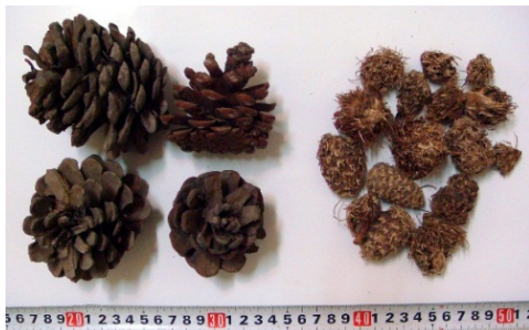
شکل ۳- مواد به دست آمده از خرد شدن مخروط کاج در خرمنکوب با تیغه لبه صاف (راست): مواد خردشده در کنار مواد اولیه؛ چپ: مقایسه هسته کاج خردنشده مخروط کاج سالم)
