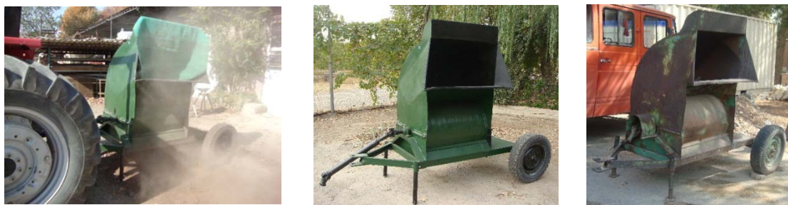
شکل ۱- مراحل بازسازی خرمنکوب (راست: پیش از بازسازی؛ وسط: پس از بازسازی؛ چپ: در حال کار)
