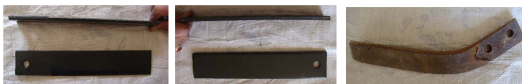
شکل ۲- طراحی و ساخت تیغه‌های جدید برای نصب روی خرمنکوب (راست: تیغه قدیمی؛ وسط: تیغه لبه صاف جدید؛ چپ: تیغه لبه تیز جدید)
