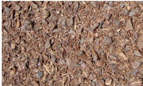
شکل ۴- مواد به دست آمده از خرد شدن مخروط کاج در خرمنکوب با تیغه لبه تیز (راست): مواد خرد و خارج شده از خرمنکوب؛ چپ: مقایسه هسته کاج خردنشده و مخروط کاج سالم)
