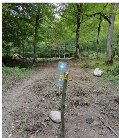
شکل ۲- باران‌سنج دستی مورد استفاده برای اندازه‌گیری مقدار باران
