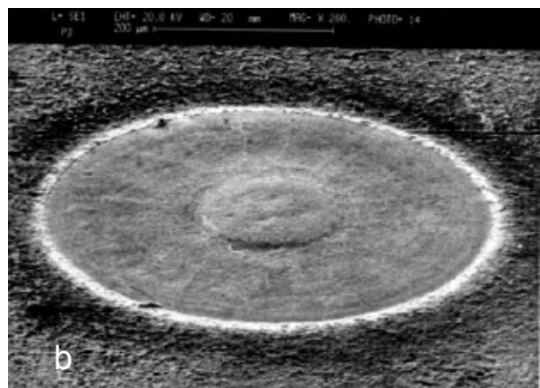
شکل ۳- مورفولوژی سطح آلیاژ تیتانیوم: (a) چگالی انرژی ۹۰ J/cm 2 ، (b) چگالی انرژی ۲۱۰ J/cm 2
