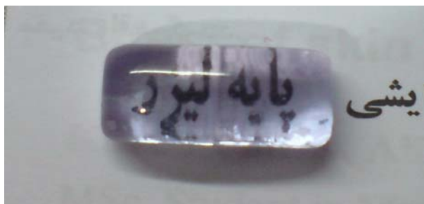
شکل ۴- تصویری از شیشه اکسی فلورایدی آلاییده به Nd^{3+}
