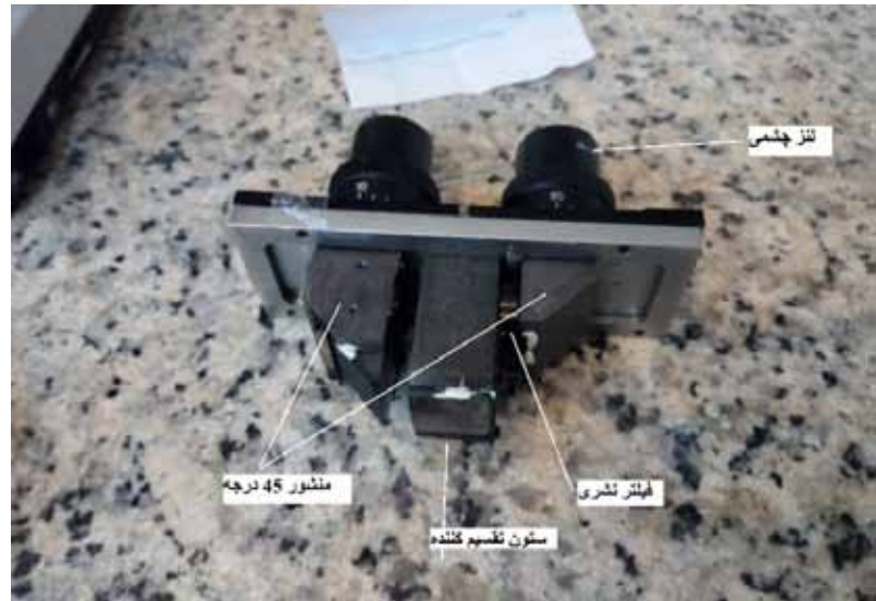
شکل ۴: ساختار هد میکروسکوپ (الف)، مسیر عبور نور منبع از هد (ب)
