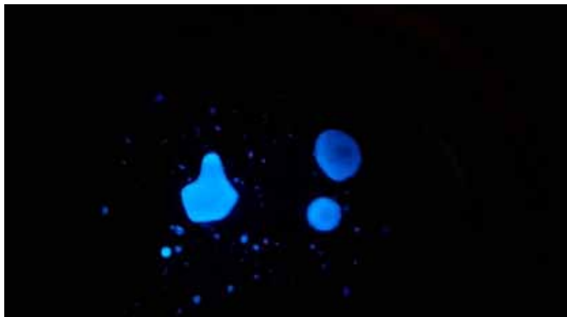
شکل ۸: تصویر میکروسکوپی فلئورسانس امولسیون قطرات بسیار ریز ترکیب Cyclo A در روغن (بزرگ‌نمایی ۲۰۰ برابر، منبع لیزر ۴۰۵ نانومتر و فیلتر نشری ۴۵۰ نانومتر)
