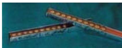
نگاره‌ی ۶: قالب آلومینیومی دارای اپوکسی رزین دربرگیرنده‌ی نمونه‌ها
