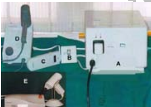
نگاره ی ۵: نمایش اجزای مختلف الگوی تابش پیشنهادی (SUP). A: ترانس تنظیم کننده ی ولتاژ، B: دیمر، C: رادیومتر، D: کولتولوکس ۴، E: آسترالیس ۷
