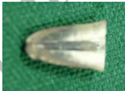
الف: اندازه ی نفوذ رنگ در نمونه ی پر شده با آپاتیت روت سیلر
