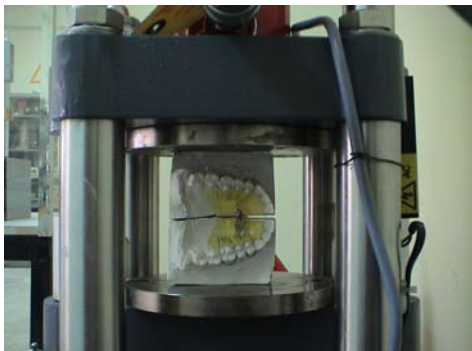
نگاره ی ۳: دستگاه متحرک به همراه پیچ طراحی شده بر روی کست با شیپار در خط میانی در درون دستگاه آزمون فشار
