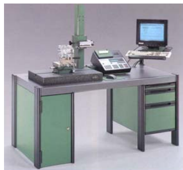
نگاره‌ی ۲: دستگاه Taly surf 10 برای اندازه گیری زبری سطحی نمونه‌ها
