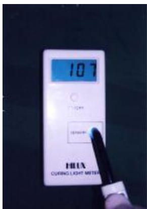
نگاره‌ی 1: چگونگی سنجش به وسیله‌ی نورسنج
