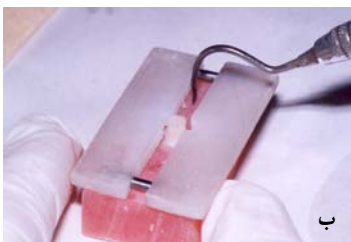
نگاره‌ی ۱ الف: مولد تفلونی نگاره‌ی ۱ ب: طرز جداسازی مولد تفلونی نگاره‌ی ۱ پ: نمونه‌ی آماده شده پیش از قرار دادن در سرم فیزیولوژی
