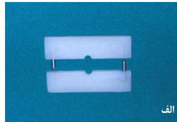
نگاره‌ی ۱ الف: مولد تفلونی نگاره‌ی ۱ ب: طرز جداسازی مولد تفلونی نگاره‌ی ۱ پ: نمونه‌ی آماده شده پیش از قرار دادن در سرم فیزیولوژی
