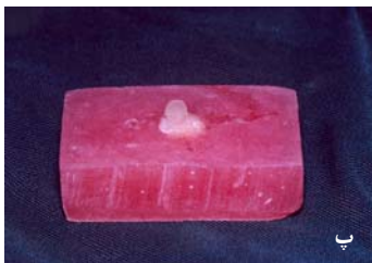
نگاره‌ی ۱ الف: مولد تفلونی نگاره‌ی ۱ ب: طرز جداسازی مولد تفلونی نگاره‌ی ۱ پ: نمونه‌ی آماده شده پیش از قرار دادن در سرم فیزیولوژی
