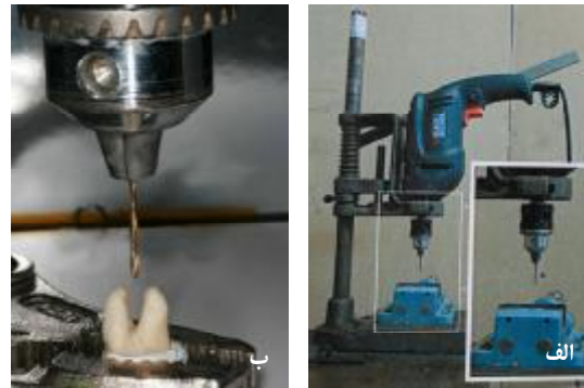
نگاره‌ی 1-الف: دستگاه استاندارد برای نگهداری دندان، ب: مسیر حرکت مته برای ایجاد حفره‌ی پرفوراسیون
