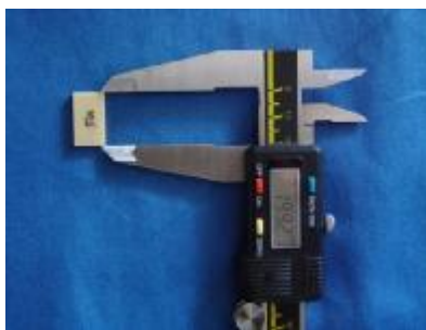
نگاره‌ی 1: اندازه‌گیری ابعاد نمونه
