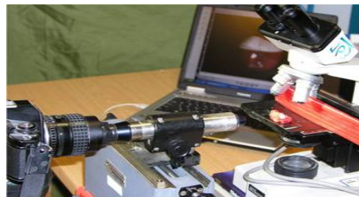
نگاره‌ی ۱ تنظیم دوربین از درون لنز کاتتومتر جهت فیلم برداری از لحظه‌ی چکاندن تا پخش شدن کامل قطره بر روی سطح عاج
