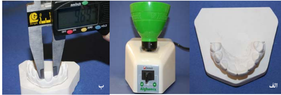
نگاره‌ی ۲ الف دستگاه آلگامیکس و قالب ریخته شده با دستگاه مزبور ب اندازه‌گیری با دقت ۰/۱ میلی متر با کولیس بر روی کست
