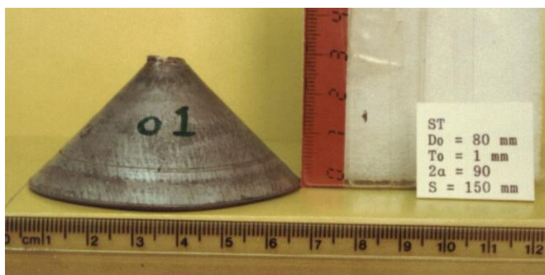
شکل ۴- نمونه مخروط با نیمزاویه رأس ۴۵ درجه فولادی شکل یافته انفجاری [۱۷]
