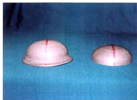
شکل ۶- تصویر عدسی‌های شکل داده شده از گرده به قطر 120 و ضخامت 3/2 میلی‌متر بدون حلقه تکیه‌گاه.
