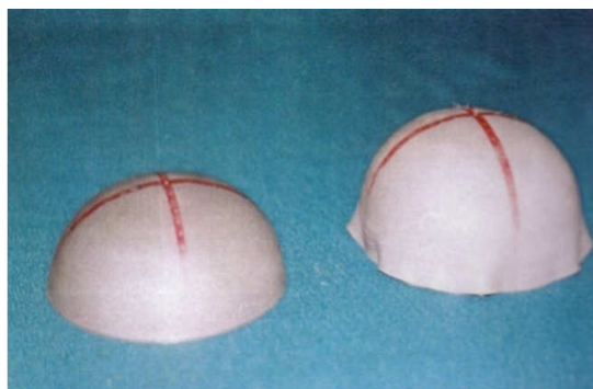
شکل ۸- توزیع کرنش محیطی و ضخامتی در نمونه تولید شده مربوط به گروه دوم.
