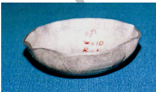
شکل ۷- تصویر عدسی‌های شکل داده شده از گرده به قطر 140 ، ضخامت 3/2 میلی‌متر روی حلقه تکیه‌گاه، قبل و بعد از برش پیرامون.
