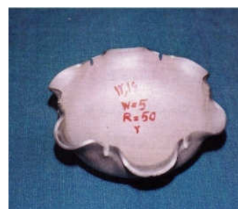
شکل ۱۱- نمونه شکل‌داده شده با شش شیار محیطی، قطر ۱۴۰ و ضخامت ۲/۲ میلی‌متر.
