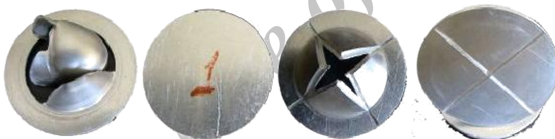
(الف) - دیافراگم شیاردار با عمق شیار ۱/۰ میلی‌متر (ب) - دیافراگم بدون شیار
