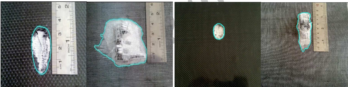
شکل ۱۵- برخورد با زاویه ۴۵ درجه در سرعت ۱۱۸ متر بر ثانیه بر روی ۴ لایه کربن- شیشه. نمای پشت پرتابه تخت نمای جلو نمای پشت پرتابه نیم کروی نمای جلو
