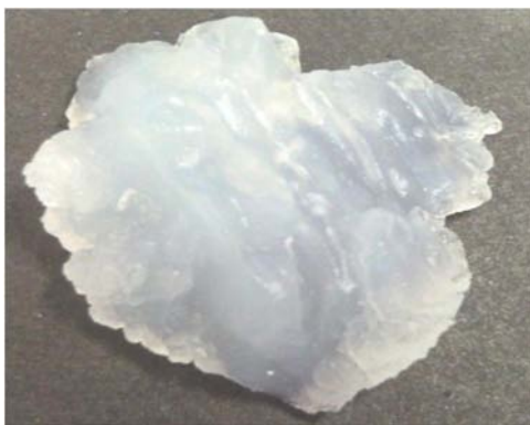
شکل 5- نمایی از ژل نیترومتان، حاوی 5% وزنی عامل ژل‌کننده ساخته شده در دمای در حدود 25°C، سرعت مخلوط کردن 1000 دور بر دقیقه و زمان مخلوط کردن 150 دقیقه.
