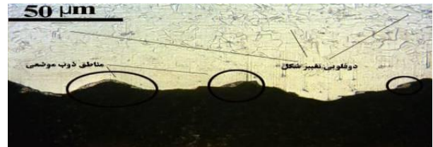
شکل 9- فصل مشترک تشکیل شده در آزمون انفجاری شماره 5.
