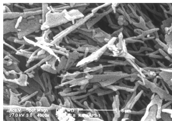
شکل 13- تصویر SEM نمونه با فعال کننده Brij 35-AOT در انجماد با سرعت پایین.
