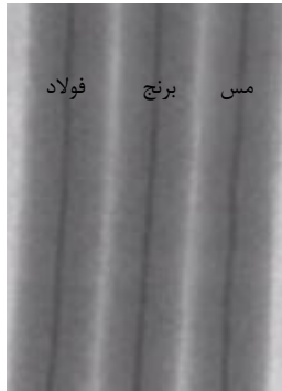
شکل ۱۲- x-ray تهیه شده از پیشرانه سیم گذاری شده با سیم مسی، برنجی و فولادی.
