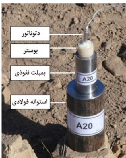
شکل ۳- شمایی از چیدمان تست نفوذ.
