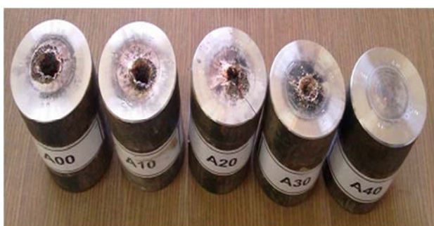
شکل ۶- اثر نفوذ نمونه‌های مختلف خرج گود در هدف فولادی.
