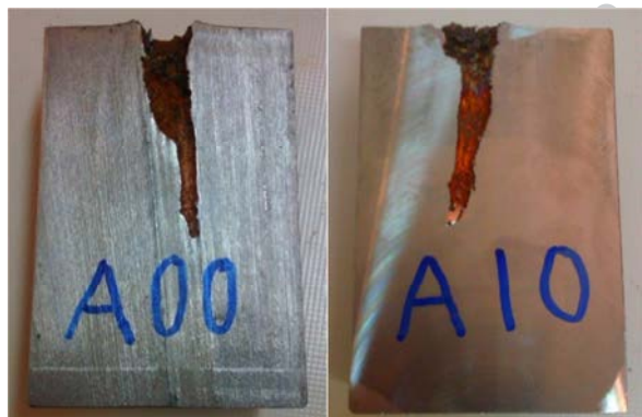
شکل ۷- حفره برش خورده هدف فولادی در تست نمونه‌های A00 و A10.
