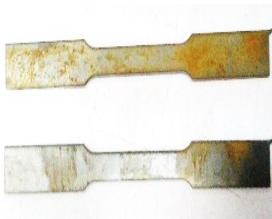
شکل ۳- نمونه ورق‌های برش خورده توسط دستگاه وایرکات.
