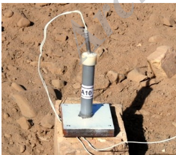
شکل ۳- چیدمان آزمون عملکردی به روش ایجاد دندان در صفحه.
