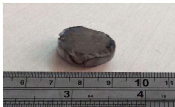
شکل ۱۱- دیسک تولید شده به روش متالورژی پودر انفجاری با ماده
