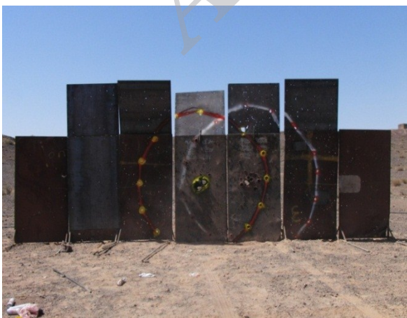
شکل ۶- محل اصابت پرتابه اصلی و پرتابه‌های محیطی در آزمون میدانی پرتابه شکل یافته چندگانه.
