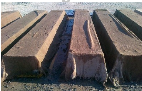
شکل ۲- آرماتورگذاری، قالب‌بندی و عمل‌آوری نمونه‌ها.
