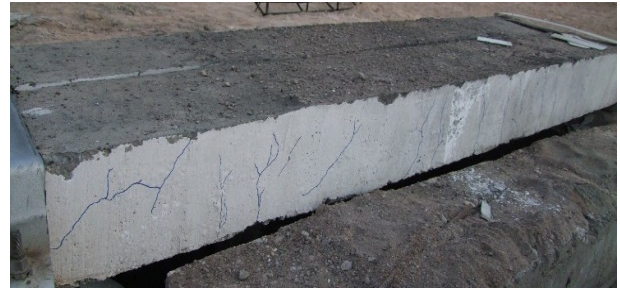
شکل ۸- وضعیت تیرها پس از انفجار ۱۲ کیلوگرم TNT.
