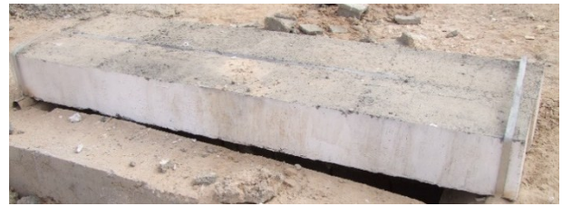
شکل ۷- وضعیت تیرها پس از انفجار ۸ کیلوگرم TNT.
