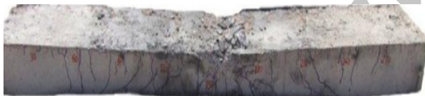
الف) ترک در بدنه جانبی تیر شماره ۱
