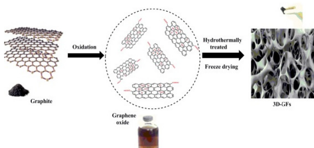
شکل ۱- تشکیل گرافن سه‌بعدی (آئروژل) [۱۷].
